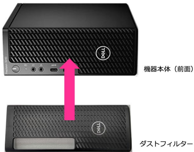
図. ダストフィルターの取り付け
