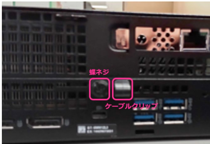
① 螺ネジとケーブルクリップ取り外す
