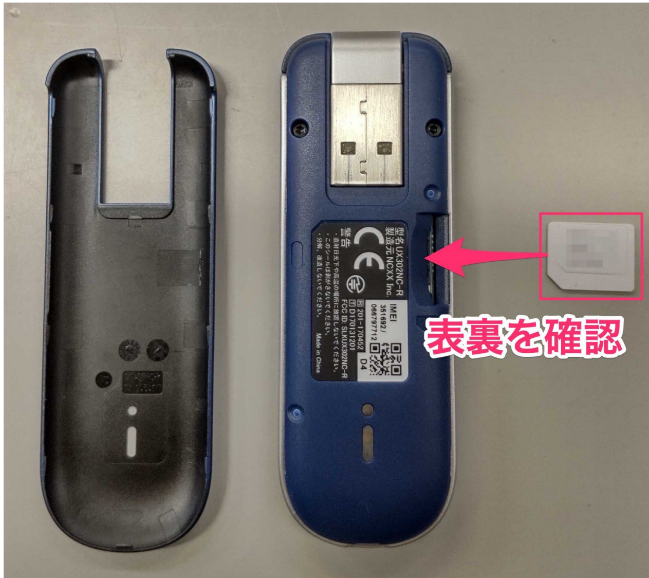
図. SIM カードの挿入方法
