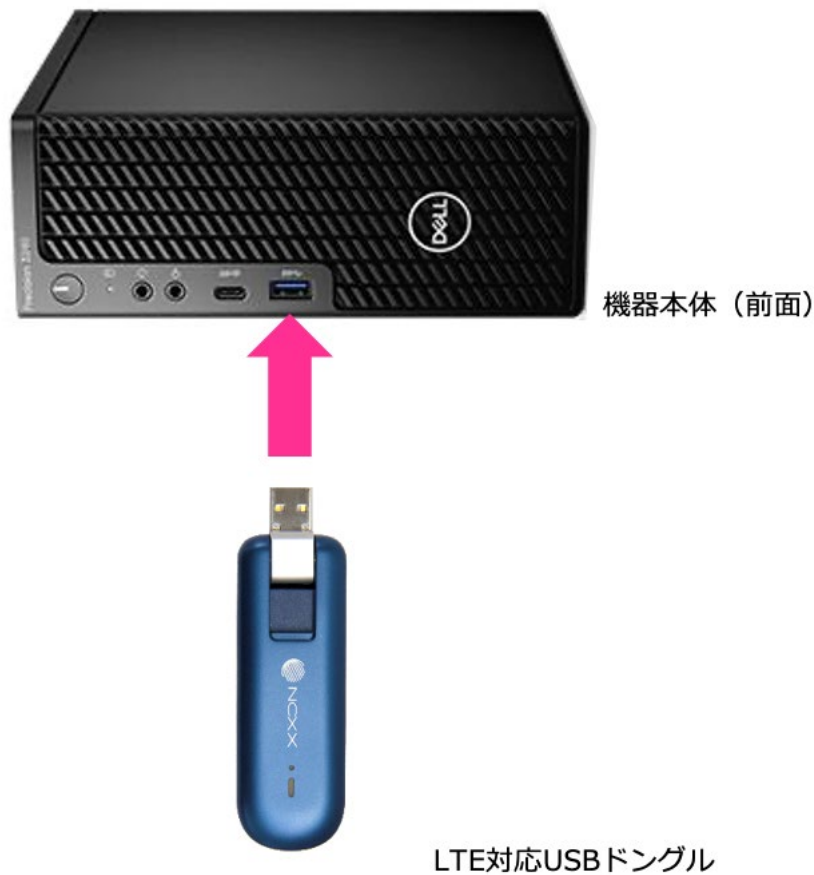
図. LTE 対応 USB ドングルの接続
