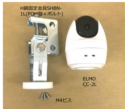
⑦カメラをH鋼に固定しLAN(UTP)ケーブルを接続する
