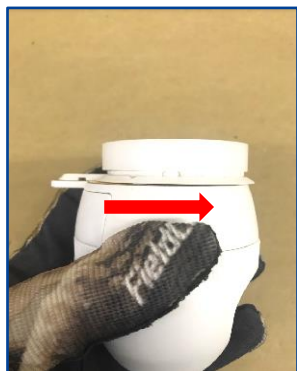
④カメラを取付板に固定する ※→方向にスライドさせて取り付ける
