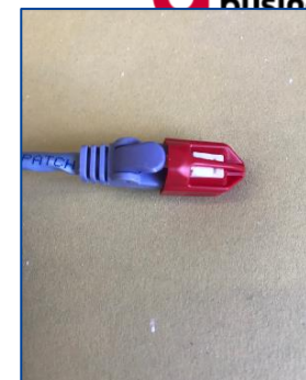
⑤付属の保護キャップをRJ45プラグに被せる
