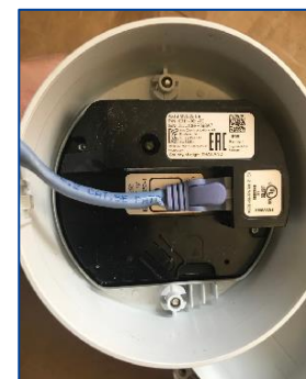
⑩LANケーブルを本体のLANポートに接続する ※カチッと音が鳴るまで差し込む
