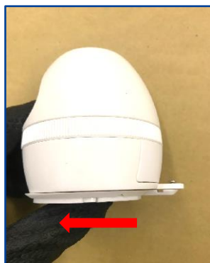
②取付板をスライドさせて取り外す ※←方向にスライドさせて取り外す
