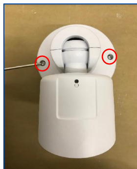
①付属のT10レンチを用い○印2か所のビスを緩め、カメラ本体をベースから取りはずす。 ※安定した場所で作業してください。
