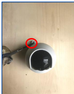
⑥カメラ本体と取付板を固定する ※①で取り外したビス
