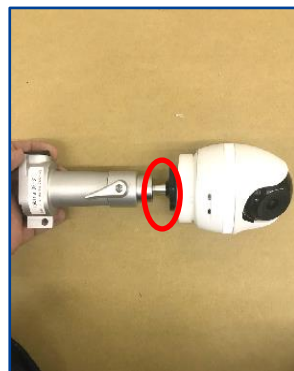
⑥カメラをダクトレールフィクサーに 固定する ※黒色ネジを回して固定
