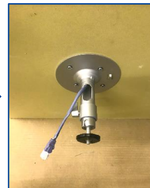
⑧フィクサーを固定しLAN(UTP)ケー ブルを通す
