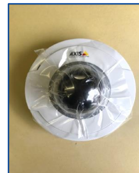
⑤カメラを固定具で固定し完了 ※フィルムを剥がして画像を確認しながら画角を調整してください。
