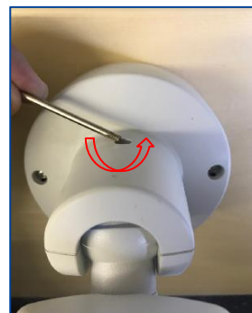
⑩保護フィルムを剥がして画角調整をする。 ※画像を確認しながら調整してください。 ※反時計回りで緩める。時計回りで締める
