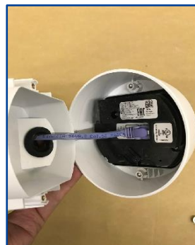
⑧LANケーブルをカメラ本体のLANポートに接続してカメラ本体とベースを閉じる
