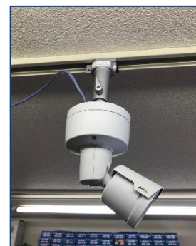
⑧完了 ※画角調整後はT10ビスを確実に締めてください。
