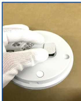
①カメラ背面のSDカード(任意)スロットの蓋を開けてSDカード(任意)を挿入する
