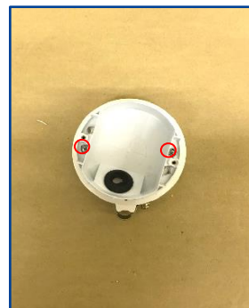
④ベースとビームラックルを固定する ※M4x20mmタッピングビスを使用し○印2か所を固定する
