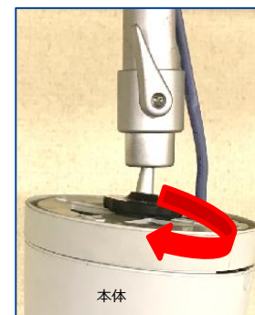
※固定するときはカメラ本体を抑えてフィクサーのネジを時計方向に回す
