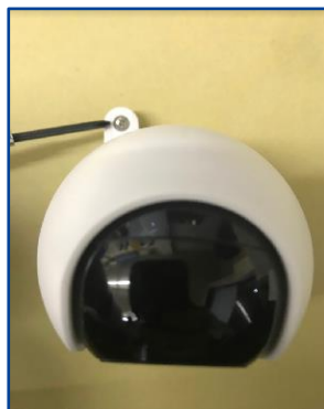
⑤カメラ本体を固定する ※①で取り外したビス
