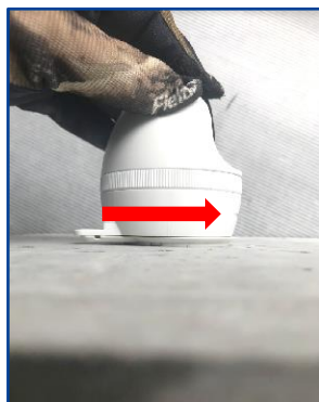
⑥カメラを取付板に固定する ※→方向にスライドさせて取り付ける
