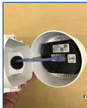
⑧LANケーブルをカメラ本体のLANポートに接続してカメラ本体とベースを閉じる
