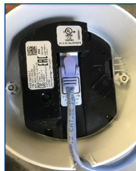
⑧LANケーブルを本体のLANポートに接続する ※カチッと音が鳴るまで差し込む
