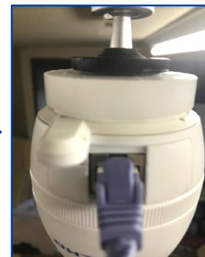
⑧LAN(UTP)ケーブルを接続する
