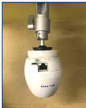
⑨カメラをフィクサーに固定し、 LANケーブルを接続する
