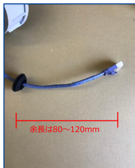
⑦LANケーブルをゴムブッシングに通す ※カメラ内の予長80-120mmにする。
