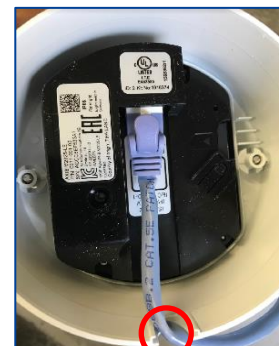
⑩LANケーブルを本体のLANポートに接続する ※カチッと音が鳴るまで差し込む ※水が当たる壁面に設置する際は○印の通線口が下になるように設置してください。
