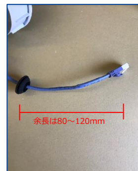
⑨LANケーブルをゴムブッシングに通す ※カメラ内の予長80~120mmにする。
