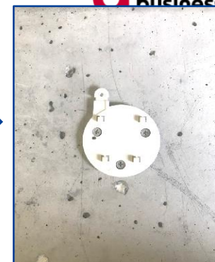
⑤設置面に取付板を固定する ※ネジを締める際は手動のドライバーもしくは低速回転の電動ドライバーをご使用ください。
