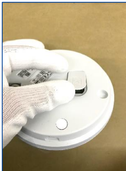
①カメラ背面のSDカード(任意)スロットの蓋を開けてSDカード(任意)を挿入する
