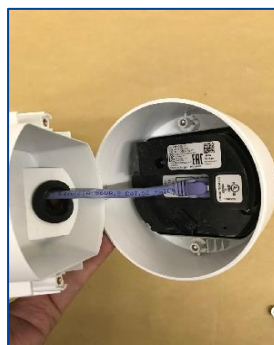
⑦LANケーブルをカメラ本体のLANポートに接続してカメラ本体とベースを閉じる ※カチッと音が鳴るまで差し込む
