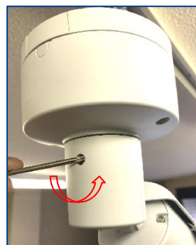
⑦保護フィルムを剥がして画角調整をする。 ※画像を確認しながら調整してください。 ※反時計回りで緩める。時計回りで締める
