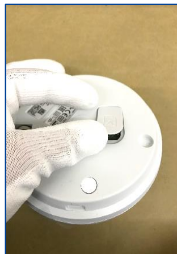
①カメラ背面のSDカード(任意)スロットの蓋を開けてSDカード(任意)を挿入する
