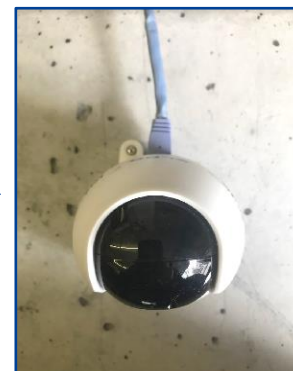
⑧LAN(UTP)ケーブルを接続する ※PoE SWもしくはインジェクター使用
