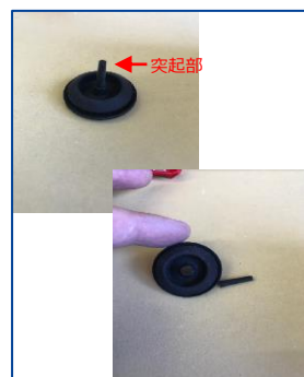
⑧付属のゴムブッシングの突起を取り外す。 ※円形部分を抑えながら突起部を引っ張ると取れます。
